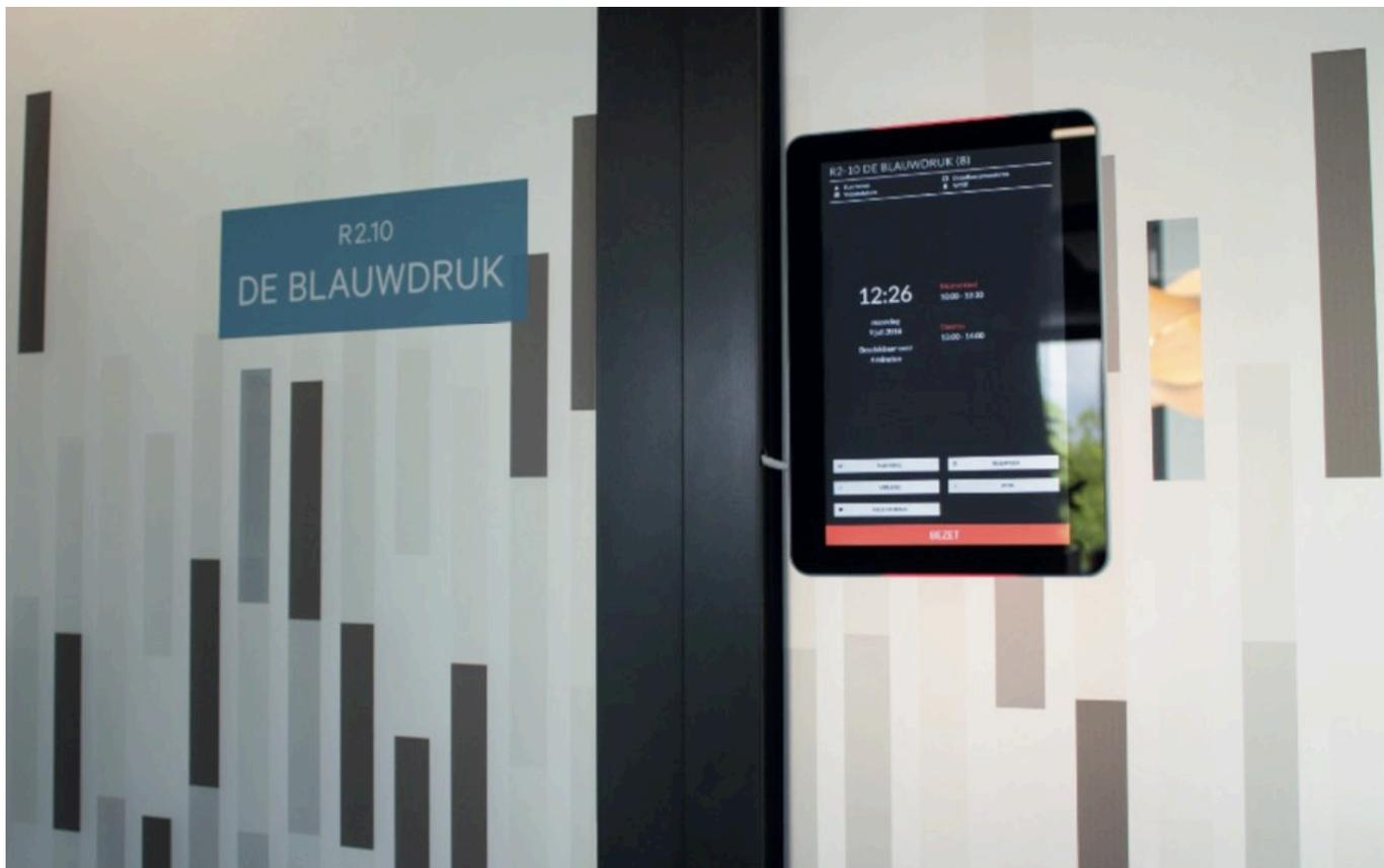
Los paneles PC Android de ProDVX tienen una potente CPU, una memoria del sistema y un almacenamiento interno más que suficientes para servir como pantallas de reserva de espacios. Disponen de Power-over-Ethernet y Wi-Fi para alimentar la pantalla y hacer funcionar su aplicación.
